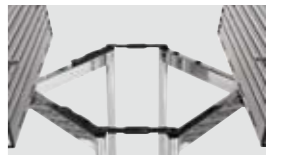
Tischverbinder in die vorgesehene Halterung einklinken. Danach die Tischplatten wieder einklinken/ Engage the table connectors in the mounting provided. Then engage the table tops once more
