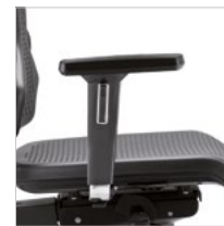
Multifunktionsarmlehnen (3 F), Auflagen PP, höhen- (10 cm), breiten- (5 cm) und tiefenverstellbar (4 cm), Armlehnenträger Aluminium poliert multifunctional armrests (3 F), soft PU arm pads, height- (10 cm), width- (5 cm) and depth-adjustable (4 cm), polished aluminium arm posts A319APO
